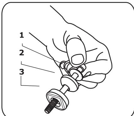
5. После того, как вы убедитесь, что отверстие в опоре расположено напротив точки крепления, вставьте винт в резьбовое отверстие крыши вашего автомобиля, затем затяните его Г-образным ключом.
