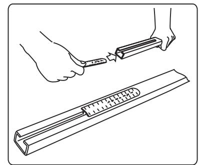
2. Вставьте линейки (A) в пазы поперечин багажника закругленным концом к центру поперечины и цифрами наружу. Пожалуйста, обратите внимание на то, что размеры линеек для передней и задней поперечин багажника могут отличаться.
