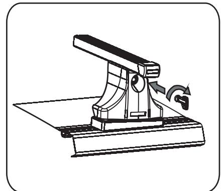
7. Потяните установленный багажник из стороны в сторону, чтобы убедиться, что он установлен надёжно. После установки груза на поперечины багажника, проверьте еще раз надежность и прочность его крепления и при необходимости подтяните винты. Периодически проверяйте состояние багажника и груза.
