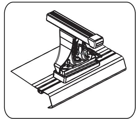
6. Установите крышку и закройте замок поворотом ключа по часовой стрелке.
