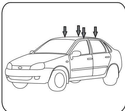
3. Поместите соответствующую (переднюю, либо заднюю) дугу багажника на крышу автомобиля так, чтобы опоры находились над штатными местами крепления багажника вашего автомобиля.
