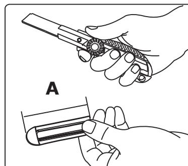
1. Для обеспечения должного расстояния между крепежными опорами багажника отрежьте линейки (A) нужного размера. Выбрать нужный размер линейки необходимо в соответствии с таблицей сборки (см. стр. 6). Оставшаяся часть линейки будет использована для уменьшения аэродинамических шумов.
